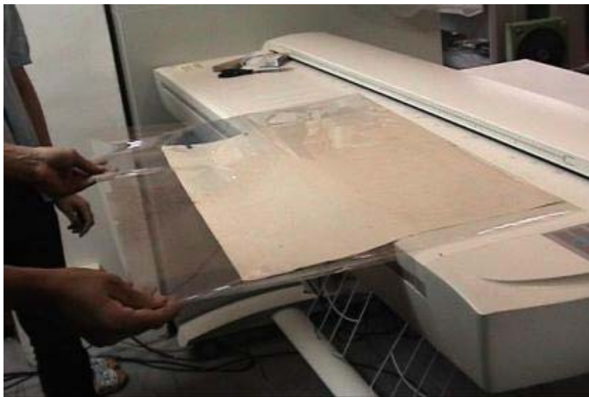
圖四：將地圖裝進透明膠套後進行掃描
