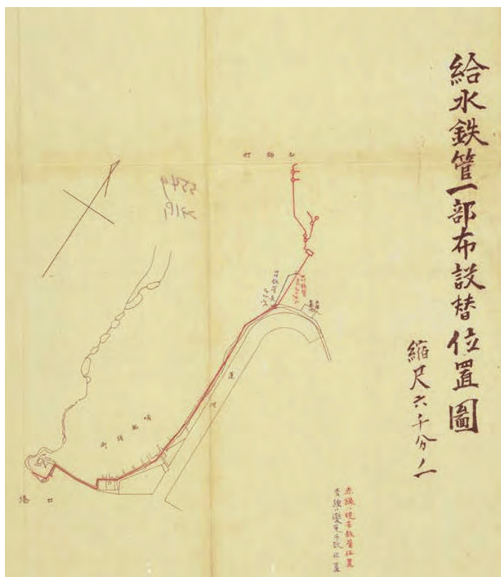
圖 3-6 大正 1 年 (1912) 哨船頭給水鐵管一部布設替位置圖 資料來源：臺灣總督府公文類纂・〈臺南廳管內保安林內ノ鐵管布設箇所一部變更認可(工事部)〉(1912)・典藏號：00005549036。
